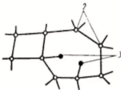
Рис.1 Фрагмент структуры аморфного гидрогенизированного кремния (2 – атом кремния , 3 – атом водорода)
